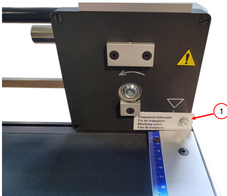
Abbildung 42 Transportschraube und Kunststoffring entfernen VARGA VA 1
