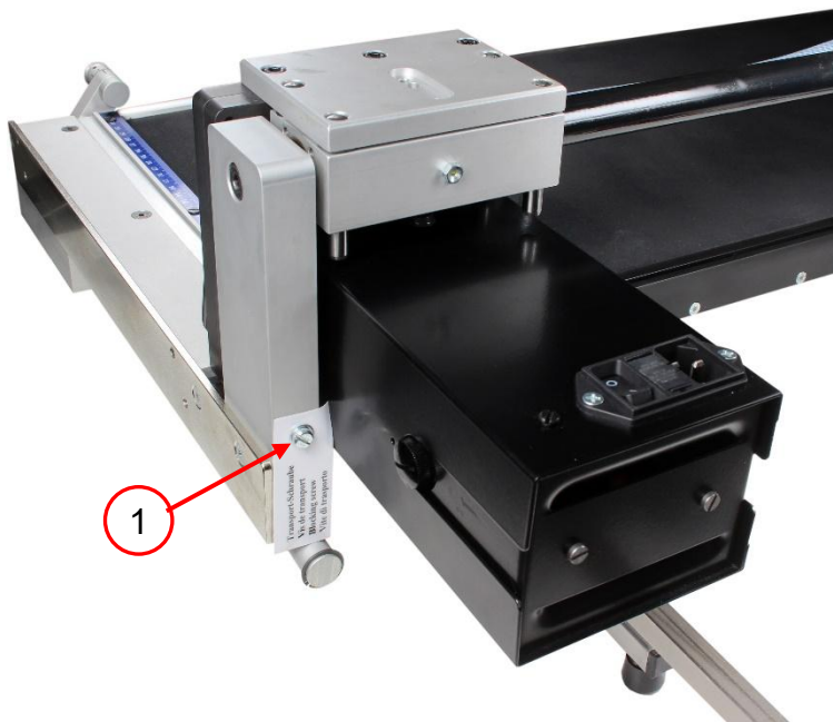
Abbildung 26 Transportschraube und Kunststoffring entfernen VARGA VA 11
