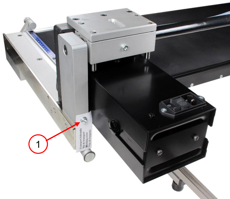
Abbildung 34 Transportschraube und Kunststoffring entfernen VARGA VA 21-15 und VA 31-15
