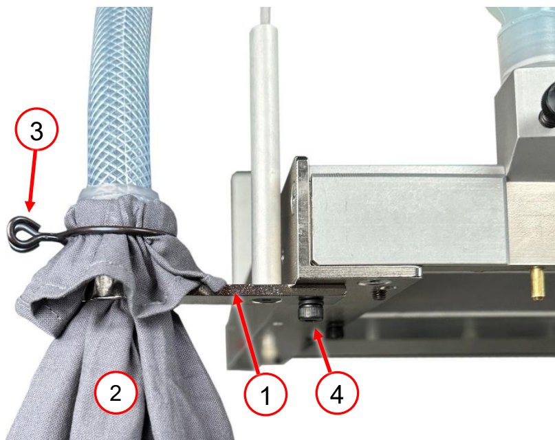
Abbildung 33 Montage Spänesack VARGA VA 21-15 und VA 31-15
